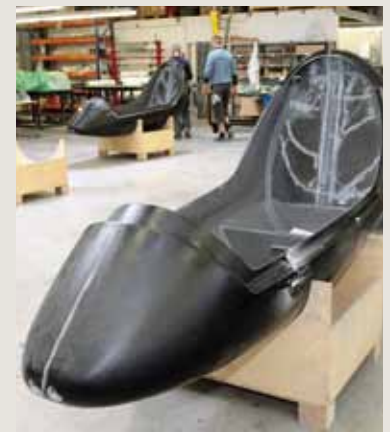
Fertig laminiertes und ausgehärtetes Monocoque
