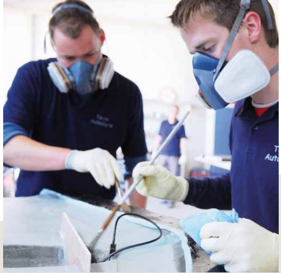
Laminierung der Faserverbundwerkstoffteile
